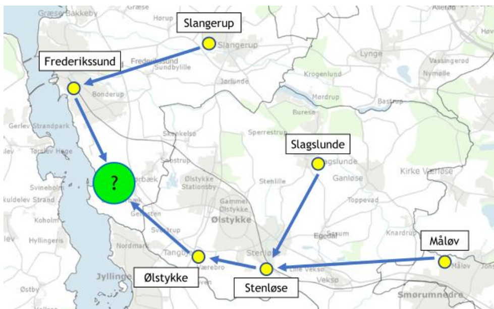
Figur 3. Scenarie 4 - Centralisering af alle renseanlæg på nyt renseanlæg. Grøn cirkel (med spørgsmålstegn) symboliserer, at der i dette scenarie skal bygges et nyt renseanlæg - den angiver ikke en specifik placering.
