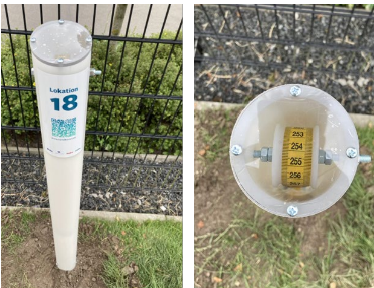
Figur 55: Automatisk IoT-logger samt citizen-science monitoring.
